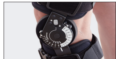
Forlængelse og bøjning kan justeres og låses fra 0° til 45° i intervaller på 10°/15°. Kontrolleret bevægelsesområde mellem 0° og 120° bestemmes let med en trykknop i intervaller på 10°/15°.
